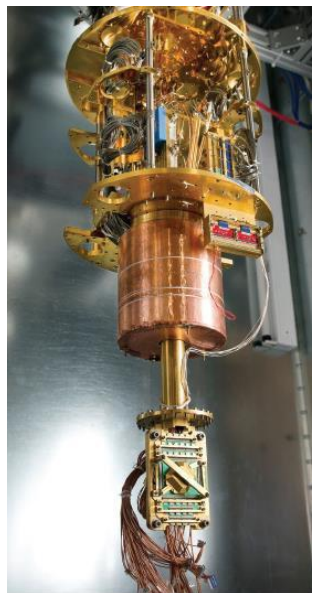
Figura 3. Procesador Quántico. Nota: Obtenido de (D-Wave, 2018)
